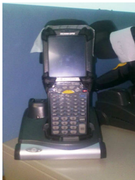
FIGURA 9: LECTOR DE MEDIDOR DE AGUA PARA FACTURACIÓN "ON LINE"
