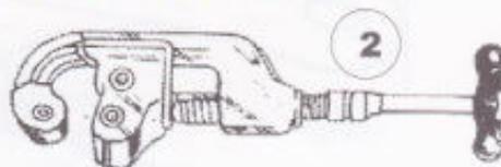
Para cortar tubos se emplea la **sierra metálica** o **segueta** (fig.1) y la herramienta **cortatubos**, que está formada por rodillos y una cuchilla circular (fig.2).
